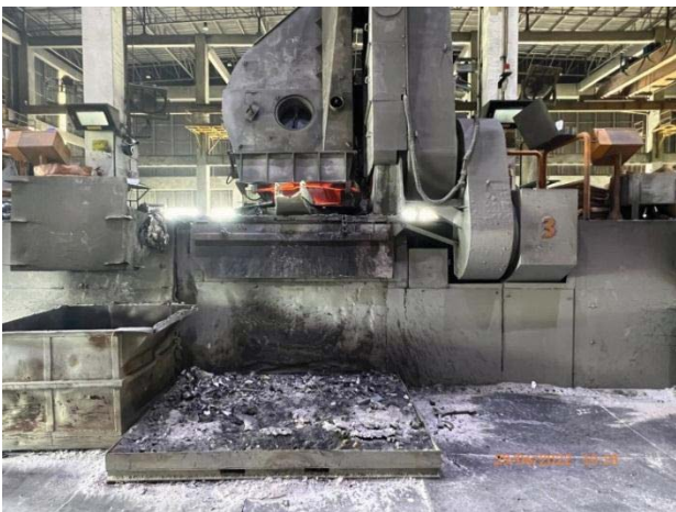
ภาพที่ 45 บ่อสำรองฉุกเฉินใต้เตาหลอม
